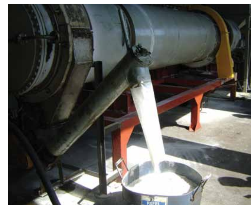
Secador a vapor (cristalização e secagem de sais de zinco - sulfato de zinco)
